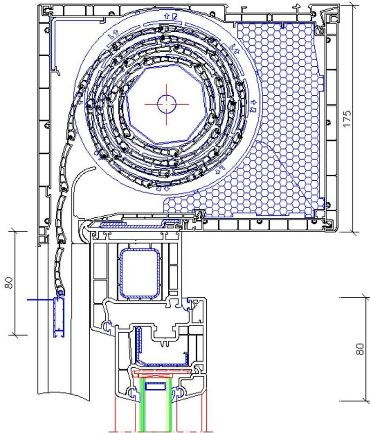
**Rolladenaufsatzelement System AV/AVE**
