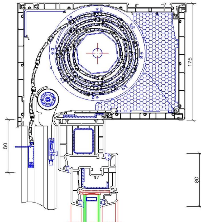
**Rolladenaufsatzelement System AV/AVE**
