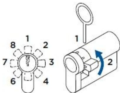
Der Einbau des Schließzylinders erfolgt mit **max. 3 mm** Überstand
