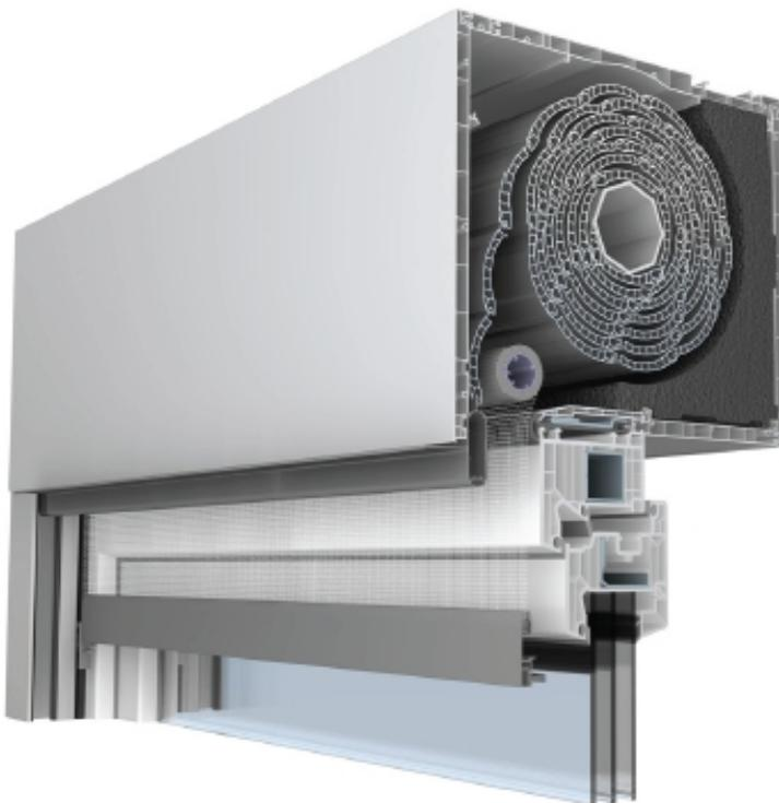
Das neue AV-Aufsatzelement von Heinzmann ist gekennzeichnet durch seine Wandelbarkeit und Anpassbarkeit an nahezu jede Bausituation. Nicht weniger als sechs Einbaumöglichkeiten bietet ein einziges Kastensystem. Der Kasten kann in seiner Grundform als kompletter Kunststoffkasten verwendet werden, wahlweise können außen, innen oder beidseitig Putzträger und Putzwinkel angebracht werden, damit der Kasten unsichtbar in die Hausfassade eingeputzt und integriert werden kann.
