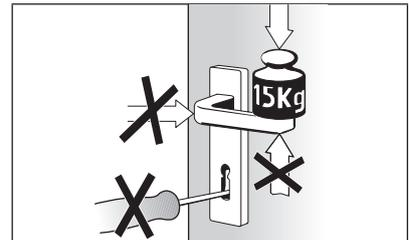
Drücker nur in Betätigungsrichtung belasten. Max. Kraft 150 N. Das Schloss darf nur mit zugehörigem Schlüssel geschlossen werden.
