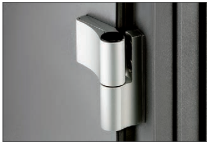
3 Türbänder dreidimensional einstellbar ohne Aushängen des Türflügels. Jedes Band verfügt über eine Tragkraft bis zu 120 kg.
