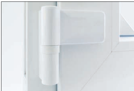
3 Türbänder dreidimensional einstellbar ohne Aushängen des Türflügels. Jedes Band verfügt über eine Tragkraft bis zu 120 kg.
