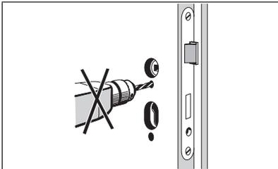
Tür bei eingebautem Schloss nicht durchbohren. Drückerstift nicht mit Gewalt einsetzen.
